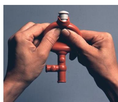
**6. Einsetzen des Automatik-Ventils**
