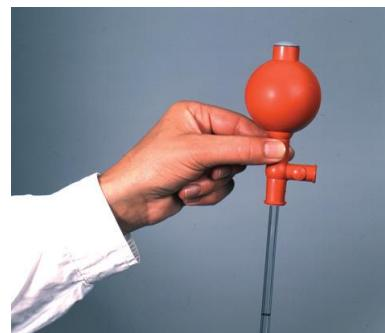
**3. Entleeren durch Druck auf den Arbeitspunkt**
